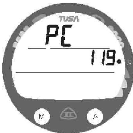
Рис. 5 (подключение к ПК)
