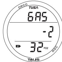
Рис. 77 - ПРЕДВАРИТЕЛЬНЫЙ ПРОСМОТР ПЕРЕКЛЮЧЕНИЯ GAS 2
