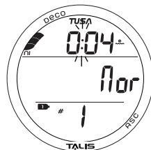
Рис. 78 - ОСНОВНОЙ ЭКРАН ПОСЛЕ ПОГРУЖЕНИЯ (первые 10 мин на поверхности)
