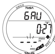
Рис. 85 - ОСНОВНОЙ ЭКРАН РЕЖИМА GAUG DV3
