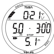
Рис. 62 - ОСНОВНОЙ ЭКРАН ОСТАНОВКИ БЕЗОПАСНОСТИ
