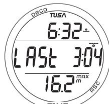
Рис. 87 - АЛЬТЕРНАТИВНЫЙ ЭКРАН 1 РЕЖИМА FREE НА ПОВЕРХНОСТИ
