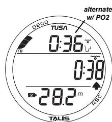
Рис. 72 - ВЫСОКИЙ УРОВЕНЬ PO2 (после звукового сигнала)
