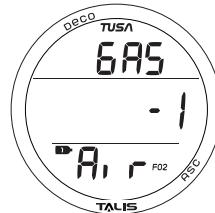
Рис. 76 - ПРЕДВАРИТЕЛЬНЫЙ ПРОСМОТР ПЕРЕКЛЮЧЕНИЯ GAS 1
