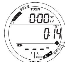
Рис. 68 - ОСНОВНОЙ ЭКРАН ОТЛОЖЕННЫХ НАРУШЕНИЙ 3
