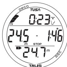
Рис. 61 - ОСНОВНОЙ ЭКРАН ГЛУБОКОЙ ОСТАНОВКИ
