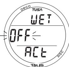
Рис. 37 - УСТАНОВКА АКТИВАЦИИ В ВОДЕ
