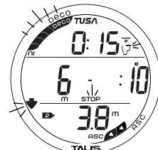
Рис. 66 - ОСНОВНОЙ ЭКРАН ОТЛОЖЕННЫХ НАРУШЕНИЙ 1
