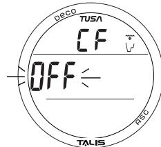
Рис.41. УСТАНОВКА ФАКТОРА КОНСЕРВАТИВНОСТИ
