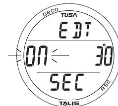
Рис. 92 - УСТАНОВКА СИГНАЛА EDT
