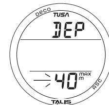
Рис. 32 - УСТАНОВКА СИГНАЛА ГЛУБИНЫ
