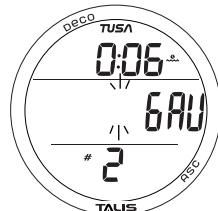
Рис. 24 - ОСНОВНОЙ ЭКРАН НА ПОВЕРХНОСТИ. РЕЖИМ GAUG (< 10 мин. после погружения)
