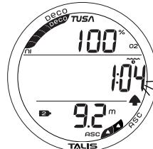
Рис. 74 - СИГНАЛ О ВЫСОКОМ УРОВНЕ О2 (декомпрессия, до выхода на поверхность)
