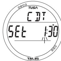
Рис. 91 - УСТАНОВКА ТАЙМЕРА ОТСЧЕТА CDT В РЕЖИМЕ "ФРИДАЙВИНГ"
