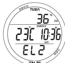
Рис. 26 - АЛЬТЕРНАТИВНЫЙ ЭКРАН НА ПОВЕРХНОСТИ. РЕЖИМ NORM
