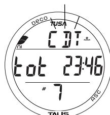
Рис. 89 - ОСНОВНОЙ ЭКРАН РЕЖИМА FREE НА ПОВЕРХНОСТИ (при сигнале CDT)
