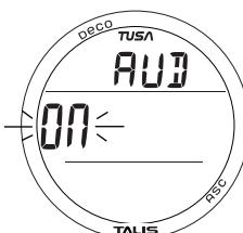
Рис. 31 - УСТАНОВКА ЗВУКОВОГО СИГНАЛА
