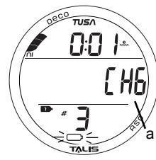
Рис. 6 – СИГНАЛ О ТОМ, ЧТО БАТАРЕЯ РАЗРЯЖЕНА
