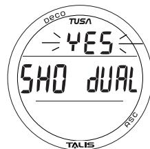
Рис. 18 - УСТАНОВКА СДВОЕННОГО ВРЕМЕНИ
