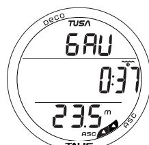
Рис. 83 - ОСНОВНОЙ ЭКРАН РЕЖИМА GAUG В ВОДЕ
