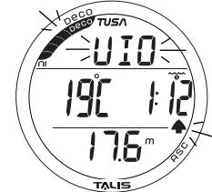
Рис. 101 - НАРУШЕНИЕ (ВХОД В РЕЖИМ ДЕКОМПРЕССИИ)
