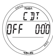
Рис. 90 - СТАТУС ТАЙМЕРА ОТСЧЕТА CDT (выкл., нет установки)
