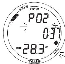
Рис. 71 - ВЫСОКИЙ УРОВЕНЬ PO2 (во время звукового сигнала)
