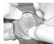
Рис. 104 - АЛЬТЕРНАТИВНОЕ СНЯТИЕ КРЫШКИ БАТАРЕЙКИ
