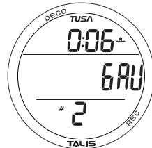
Рис. 81 - ОСНОВНОЙ ЭКРАН РЕЖИМА GAUG НА ПОВЕРХНОСТИ
