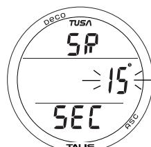
Рис.43. УСТАНОВКА ЧАСТОТЫ ИЗМЕРЕНИЙ
