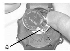
Рис. 105 - ИЗВЛЕЧЕНИЕ БАТАРЕЙКИ
