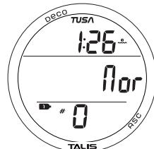
Рис. 23 - ОСНОВНОЙ ЭКРАН НА ПОВЕРХНОСТИ. РЕЖИМ NORM
