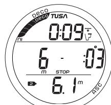
Рис. 64 - ОСНОВНОЙ ЭКРАН ДЕКОМПРЕССИОННОЙ ОСТАНОВКИ
