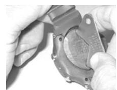
Рис. 108 - УСТАНОВКА КРЫШКИ БАТАРЕЙКИ (инструментом)
