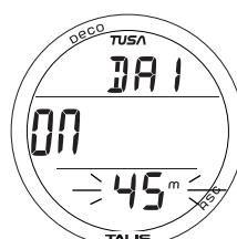
Рис. 93 - УСТАНОВКА СИГНАЛА ГЛУБИНЫ
