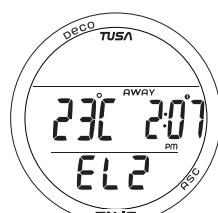
Рис. 82 - АЛЬТЕРНАТИВНЫЙ ЭКРАН РЕЖИМА GAUG НА ПОВЕРХНОСТИ
