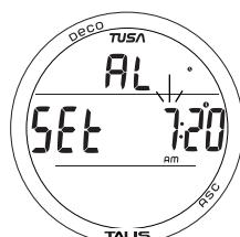
Рис. 11В - УСТАНОВКА БУДИЛЬНИКА ALARM
