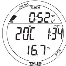
Рис. 94 - РЕЖИМ «ФРИДАЙВИНГ», ОСНОВНОЙ ЭКРАН
