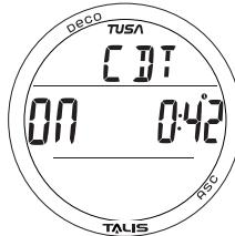
Рис. 95 - РЕЖИМ «ФРИДАЙВИНГ», ЭКРАН ALT 1
