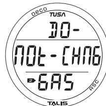
Рис. 75 - СИГНАЛ - НЕ ПЕРЕКЛЮЧАТЬ ГАЗОВУЮ СМЕСЬ
