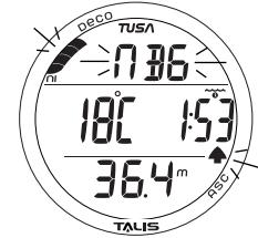
Рис. 100 - СИГНАЛ ОБ УРОВНЕ НАСЫЩЕНИЯ АЗОТОМ
