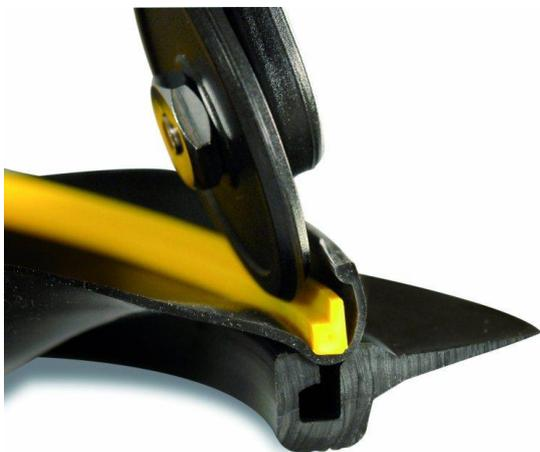
3. Установите инструмент Neck Tite в положение, как показано на фото. Прикладывая усилие, вдавите уплотнительное кольцо в канавку полиуретанового кольца так, чтобы уплотнительное кольцо пошло в канавку и замкнулось в посадочном месте. Для этой операции используйте плоскую поверхность.
