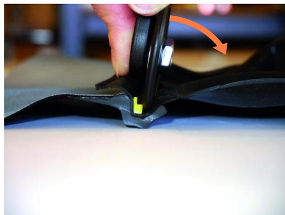
3. Когда инструмент достигнет дна канавки, самое время выгнуть уплотнительное кольцо инструментом наружу из канавки.
