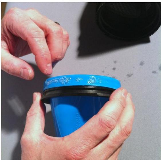
6. Нанесите смазку на водной основе на обтюратор и на внутреннюю поверхность полиуретанового кольца. Лучше нанести больше смазки, чем меньше. Кольцо с обтюратором проскользнет легче.
