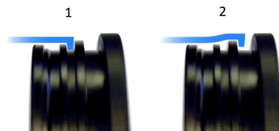
Эти рисунки показывают два способа расположения обтюратора, в зависимости от конструкции и материала сухого гидрокостюма, и от того как полиуретановое кольцо вклеено в гидрокостюм. Один из способов будет работать лучше другого. Важно попробовать оба и посмотреть, какой будет лучше. На фабрике обтюраторы при сборке устанавливаются в положение 1. Если после смены обтюратора или кольца происходит протекание, попробуйте установить обтюратор в положение 2.
